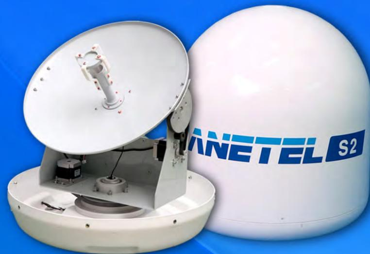
SANETEL-S 系列船载卫星电视接收天线可在各种海洋气象条件下自动搜索、识别、跟踪卫星信号，实时接收同步轨道卫星的电视节目信号，并高精度对准预设卫星，确保电视接收信号连续不间断。系统可安装在渔船、游艇、商船、钻井平台等移动载体上，是海上作业者了解国家时政、气象、海浪预报及娱乐信息等资讯的必备利器。
