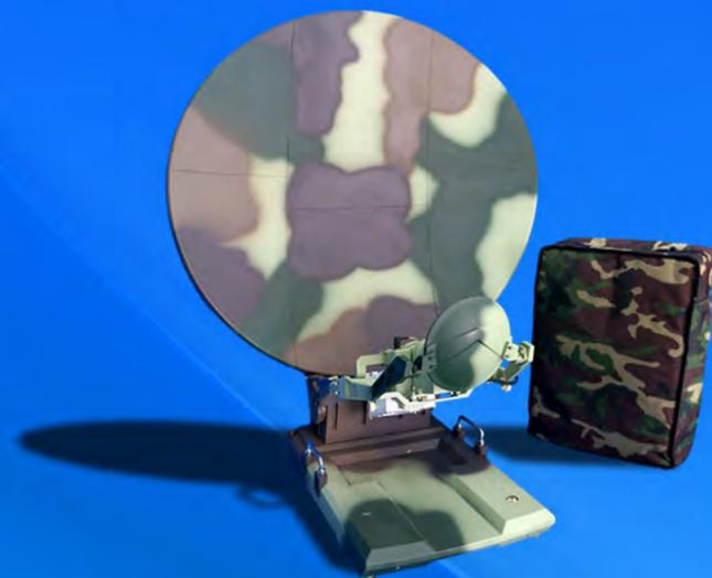
SANETEL-P 系列抛物面便携式卫星通信天线是针对城市应急及野外通信需求开发的一款全自动、高性能卫星通信天线。系统安装简单，无须校准；具备全自动一键对星功能，天线展开、对星、跟踪、调整、收起均可自动完成；系统重量较轻，可单人背负或拉行；操作者可通过手持机或 PC 机软件对系统进行设置；系统成功经历漠河极端温度测试。
